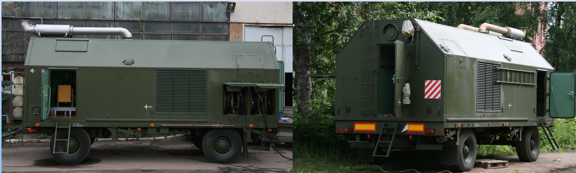
Дизельная электростанция ДЭС-315
