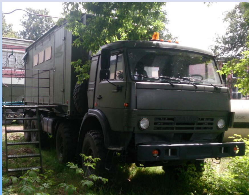
Технологическое отделение на шасси автомобиля КАМАЗ-63501.
