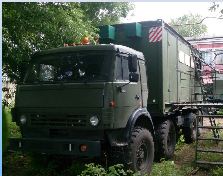
Компрессорное отделение на шасси автомобиля КАМАЗ-63501.
